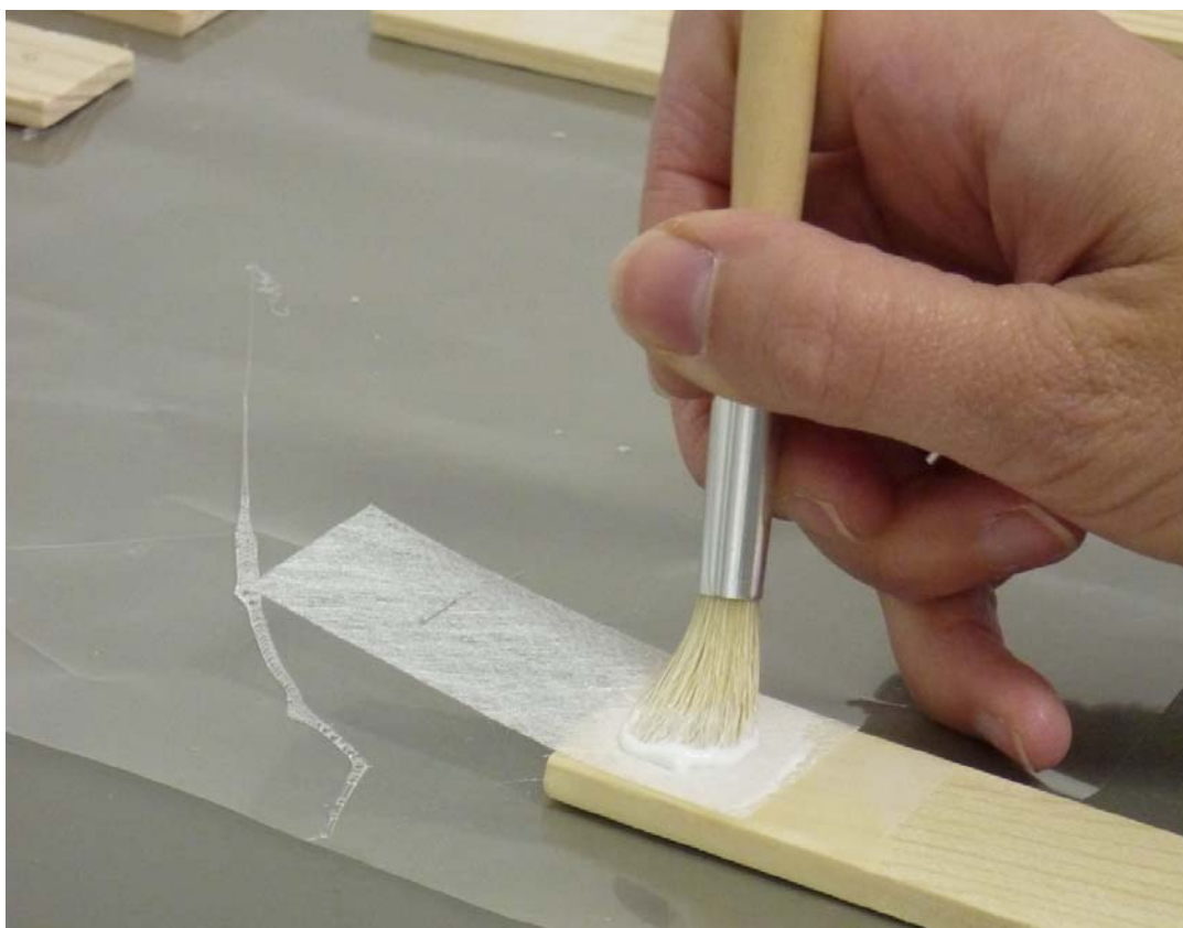
Figure 5: Application de l'émulsion Lascaux 360HV à travers le non-tissé.
