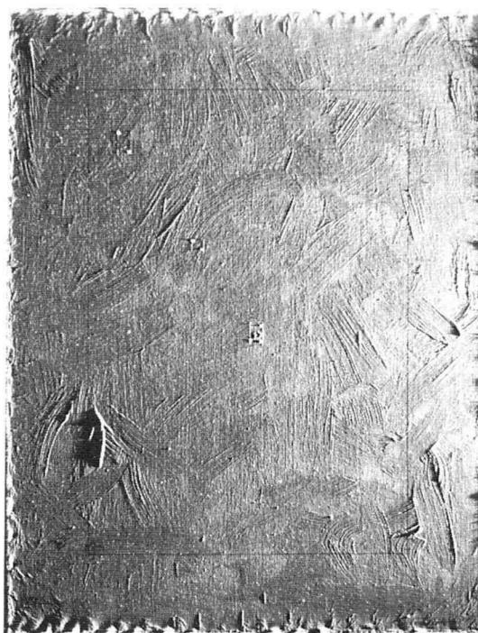
Figure 13 Photo en lumière rasante de l'éprouvette B. La densité de craquelures D_{craq} = 0,20\% après 167 jours de vieillissement hygrométrique.
