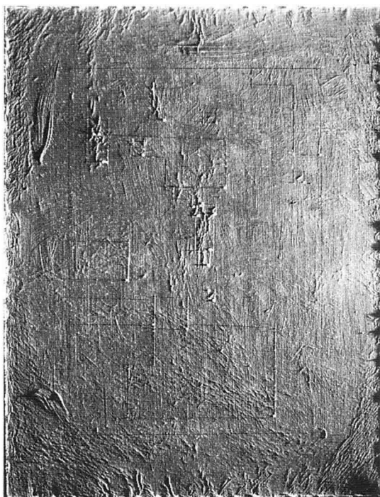
Figure 10 Photo en lumière rasante de l'éprouvette A. La densité de craquelures D_{craq} = 22,24\% après 167 jours de vieillissement hygrométrique.
