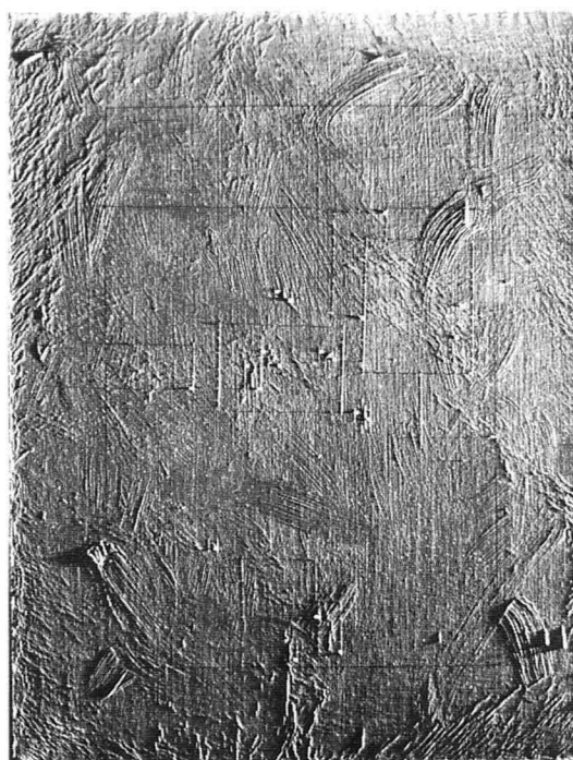
Figure 11 Photo en lumière rasante de l'éprouvette C. La densité de craquelures D_{craq} = 17,32\% après 167 jours de vieillissement hygrométrique.
